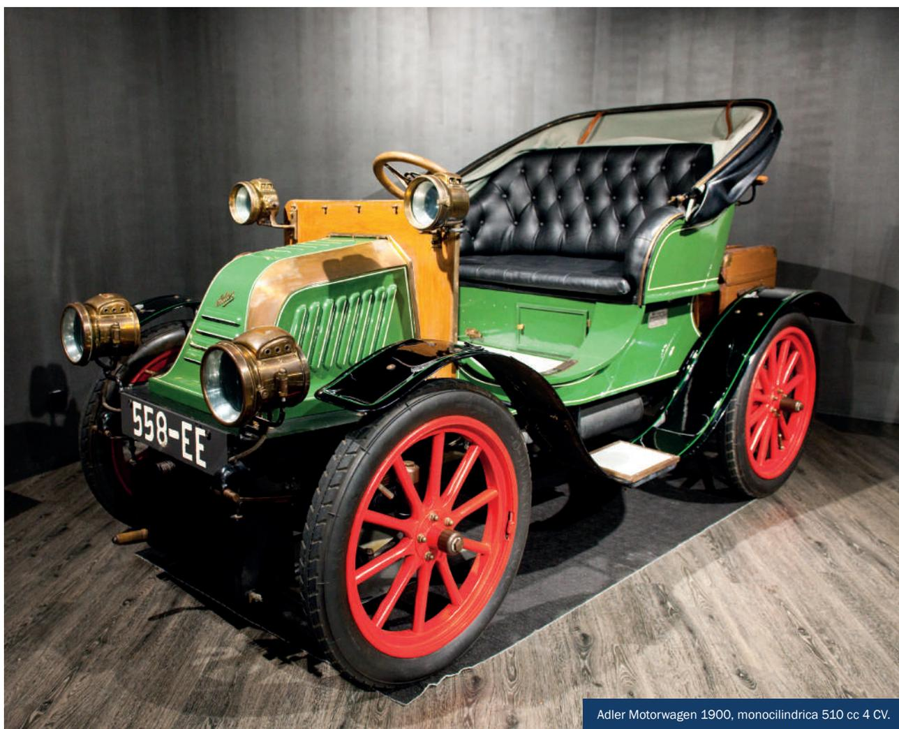
Adler Motorwagen 1900, monocilindrica 510 cc 4 CV.
