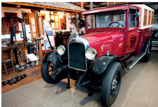
Citroën Tipo B 15 motore 1.539 cc quattro cilindri 22 CV carrozzato autobus da hotel in Germania 1926-1928. Capacità di carico 1 ton. Unico veicolo storico straniero in mostra ad Autovision.
