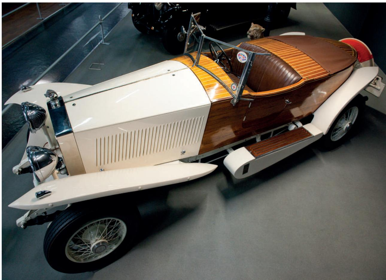
La Rolls-Royce Phantom II Boattail Tourer del 1933 ricarrozata nei primi anni Cinquanta su disegno di Hooper usando legno di tek del Kenya per il rivestimento delle fiancate posteriori e della coda.
