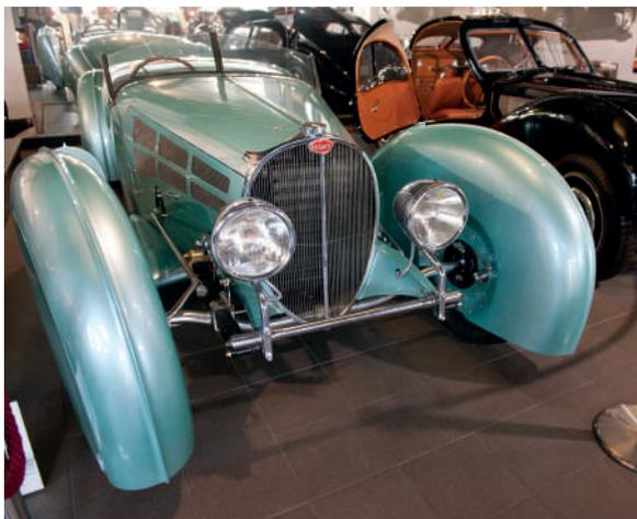
La show car disegnata da Jean Bugatti per il Salone dell'Automobile a Parigi 1936 sul telaio 57S. Disegno vistoso, poco in linea con il rigore stilistico della marca. Ruote anteriori coperte da una carenatura sterzante assieme alle ruote. Replica moderna.
