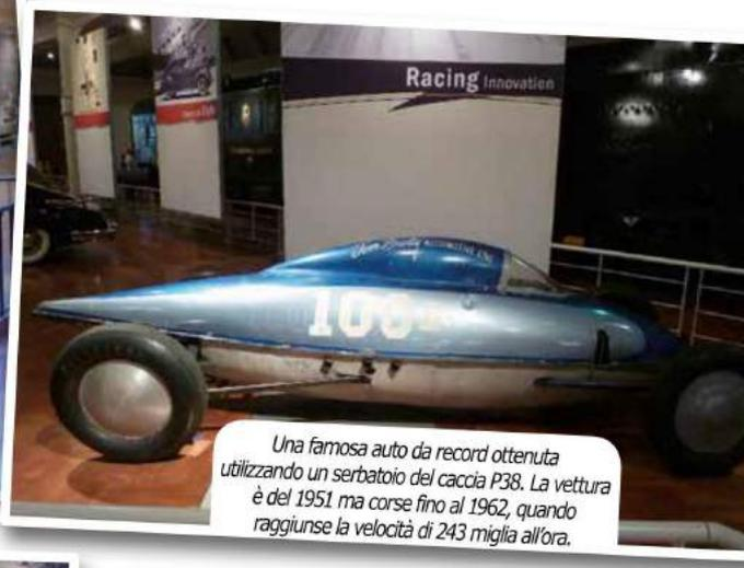
Una famosa auto da record ottenuta utilizzando un serbatoio del caccia P38. La vettura è del 1951 ma corse fino al 1962, quando raggiunse la velocità di 243 miglia all'ora.
