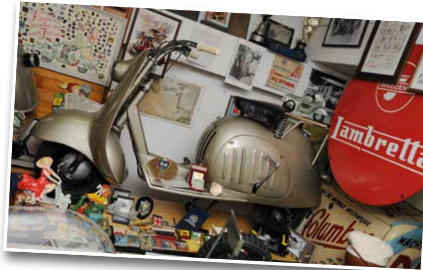
Il Bianca Nibbio 98 del 1947, caratterizzato da un'estetica molto curata e dal lungo canotto di sterzo, con tutta la parte anteriore che sterza insieme alla ruota.
