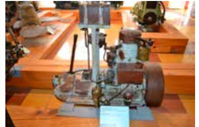
Il propulsore Bolinder-Italia a testa calda degli anni '30. Commercializzato dalla Società Anonima Motori per la Pesca, era in grado di erogare 10 CV.
