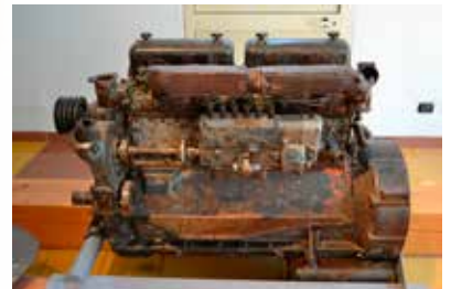
Lo Scania-Vabis "Royal" è il primo diesel realizzato da quest'azienda. È stato prodotto dal 1939 fino al 1949. Venduto con propulsori a 4 o 6 cilindri (con potenze variabili da 50 a 115 HP), ha avuto un grande successo per la sua affidabilità ed economicità. È stato il primo motore "modulare" prodotto dalla Scania: componenti comuni venivano utilizzati su diverse versioni di vari propulsori.
