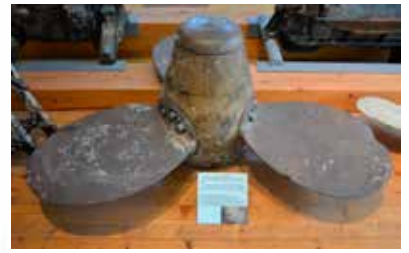
Un'elica Ansaldo a passo variabile del 1962. Con la diffusione della motorizzazione, le eliche e le tecnologie ad esse applicate hanno un ruolo molto importante.
