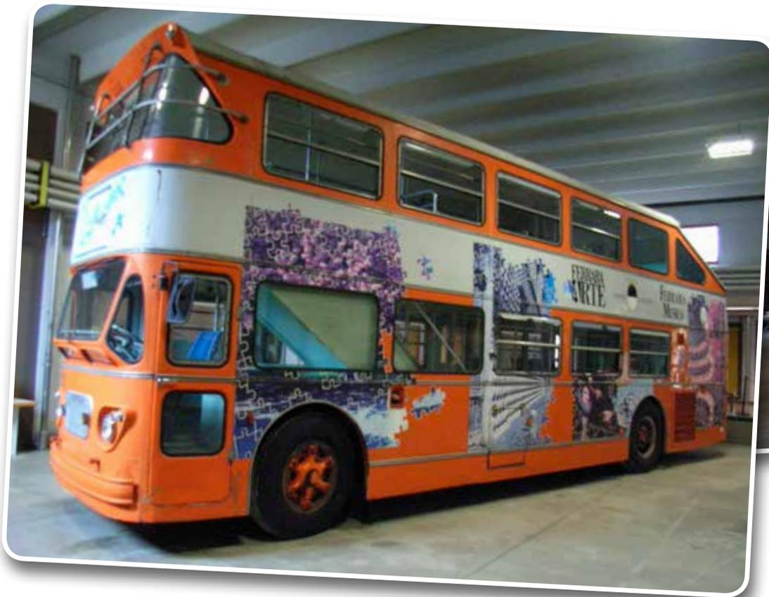
L'autobus bipiano Fiat 412H. Realizzato nel 1970, ha un propulsore a gasolio da 175 CV. La velocità massima "di servizio" è di 50 km/h. Lungo 12 metri e largo 2,5, ha un peso a vuoto di 8.800 kg (quello in servizio è di 16.990 kg). Può trasportare 127 persone
