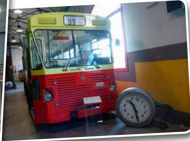
Il Fiat 421/A della collezione, allestito dalla Menarini, è stato costruito nel 1973. Ha un motore diesel da 225 CV. Lungo quasi 10,98 metri, è largo 2,5. Il suo peso a vuoto è di 10.730 kg (quello in servizio è di 16.850). Può trasportare fino a 102 persone. Il 2 agosto 1980, giorno della strage alla Stazione di Bologna, è stato utilizzato per trasportare le vittime dell'attentato.
