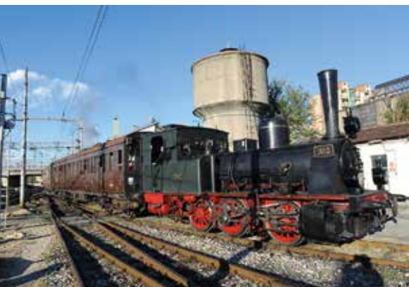
Locomotiva a vapore per servizio misto "N° 3", uscita dall'azienda Henschel nel 1907. È appartenuta alla Ferrovia della Valle Sessera (linea Grignasco-Coggiola), che ne acquistò tre esemplari. Costruite in migliaia di pezzi, sono note come "T3", termine derivante dalla classificazione delle Ferrovie Prussiane (che ne furono i principali acquirenti).
