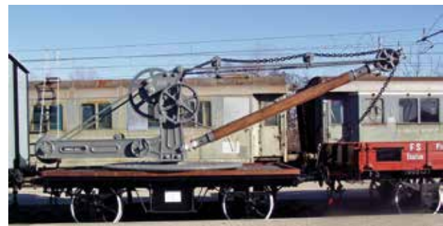
Il carro con gru manuale della Ferrovia Torino-Ceres, realizzato dalla ditta J. Bellefroid nel 1860 circa. Non dispone di alcun tipo di freno: è dotato di 4 speciali pinze per l'ancoraggio alle rotaie durante le operazioni di sollevamento.
