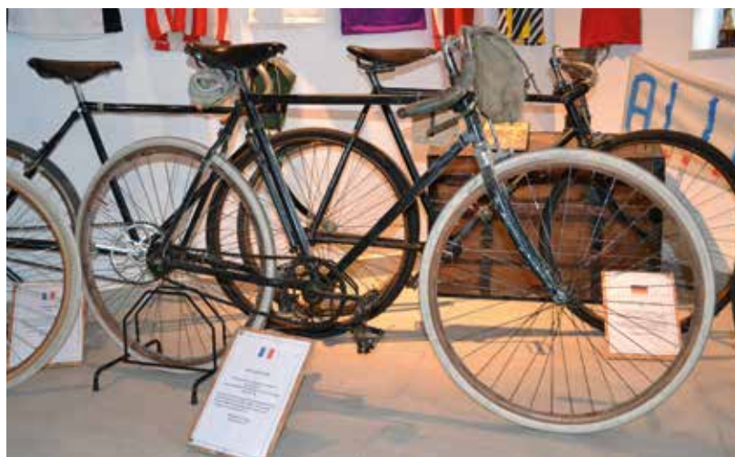
La Peugeot del 1909 con sistema frenante misto: anteriore a tampone e posteriore a contropedale. Con una bicicletta del "leone" Petit Breton ha vinto il tour negli 1907 e nel 1908.
