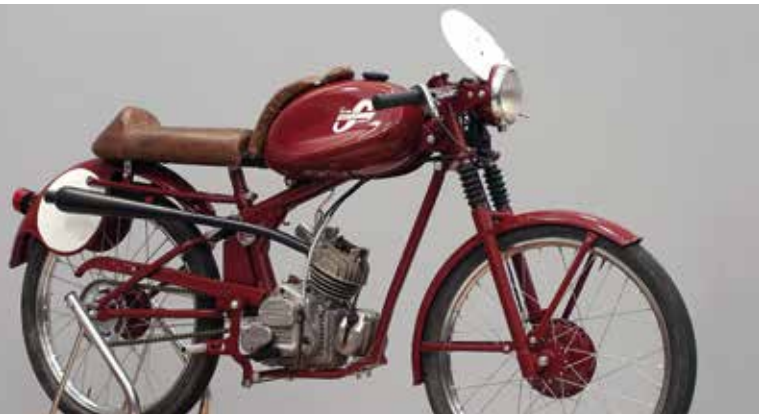
Un "Cucciolo" da competizione, equipaggiato con il piccolo motore inizialmente nato per essere applicato alle biciclette. Quello di questo mezzo ha un alesaggio di 39 mm e una corsa di 40 mm (48 cm 3 ) ed eroga 6 CV a 7.500 giri. Il cambio è a 3 velocità. Il suo peso è di soli 47 kg e può raggiungere i 97 km/h.
