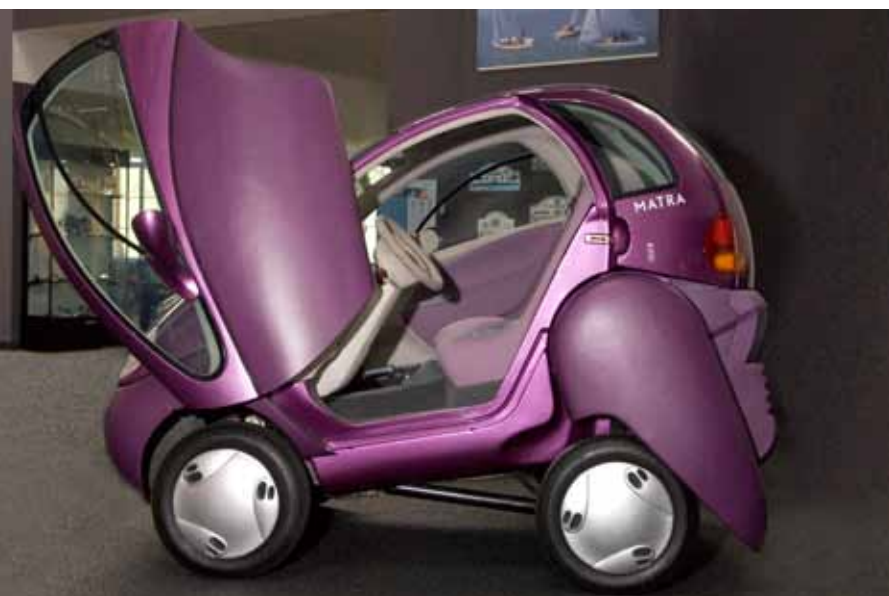
La "Zoom", vettura a passo variabile presentata al salone di Parigi nel 1992. Equipaggiata con un propulsore elettrico, ha un'autonomia di 120 km e può raggiungere i 120 km/h. Grazie a due "cilindri" si piega su se stessa, passando da una lunghezza di 2,65 a 2,10 metri, ingombro che le permette di stazionare perpendicolarmente tra due vetture parcheggiate.
