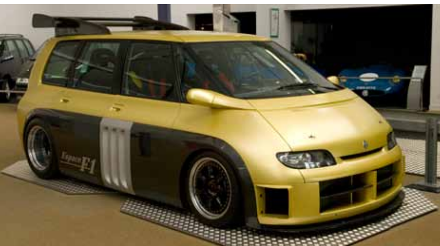
Tra i veicoli esposti anche questo prototipo con la carrozzeria dell' "Espace". Realizzato nel 1994 per celebrare i primi 10 anni di partnership tra la Matra e la Renault, questa F1 a 4 posti è equipaggiata con il telaio e il motore di 830 CV della Williams-Renault con la quale Alain Prost era diventato Campione del Mondo nel 1993. La velocità di punta era superiore a 300 km/h.
