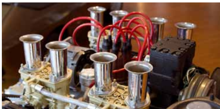
In alto, particolare del propulsore L 240 studiato per l'Urraco. La potenza nella versione di 2,5 litri è di 220 CV (erogati a 7.500 giri/min). Tra le due bancate sono alloggiati l'alternatore, lo spinterogeno, la pompa dell'acqua e il compressore dell'aria condizionata. A destra, LM 002, fuoristrada con propulsore V 12 prodotto dalla Lamborghini tra il 1986 e il 1992 in 301 esemplari (di cui 157 a iniezione).
