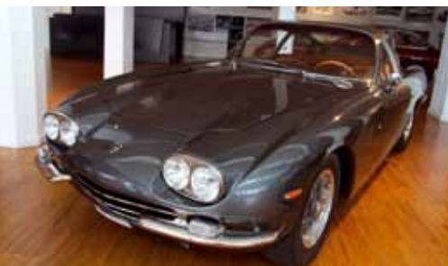
La 400 GT 2+2, prodotta tra il 1966 e il 1968, ha un motore di 4 litri. I doppi fari sono necessari per l'omologazione in USA. È stata costruita dalla Carrozzeria Touring in 250 esemplari (di cui 23 a due posti).
