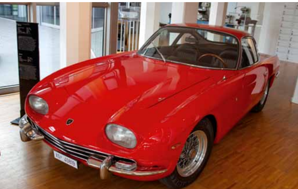
La 350 GT è stata prodotta tra il 1964 e il 1966. È la prima Lamborghini ad entrare in produzione, derivata dal prototipo 350 GTV (ideato da Franco Scaglione). Il propulsore di questa vettura, progettato dall'ingegner Giotto Bizzarrini, è un 12 cilindri a V di 3,5 litri. La potenza è di 280 CV. La carrozzeria Touring di Milano ha realizzato 120 esemplari di questo modello (più due spyder chiamate 350 GTS).
