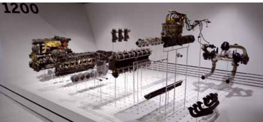
Interessante lo spaccato dei componenti del motore 12 cilindri turbo della 917/30 che, con i suoi 1.200 CV è uno dei motori più potenti della storia Porsche.
